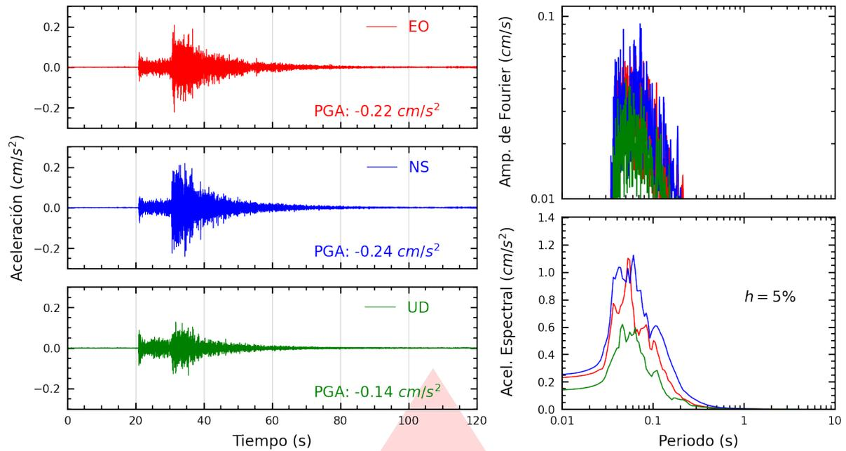
**Figura A.1:** Registros tiempo-historia, espectros de Fourier y de respuesta en las direcciones EO, NS y vertical de la estación UNSA2. Sismo de Quilca, Camana - Arequipa del 2025-09-18, 14:16:27 (Hora local)
