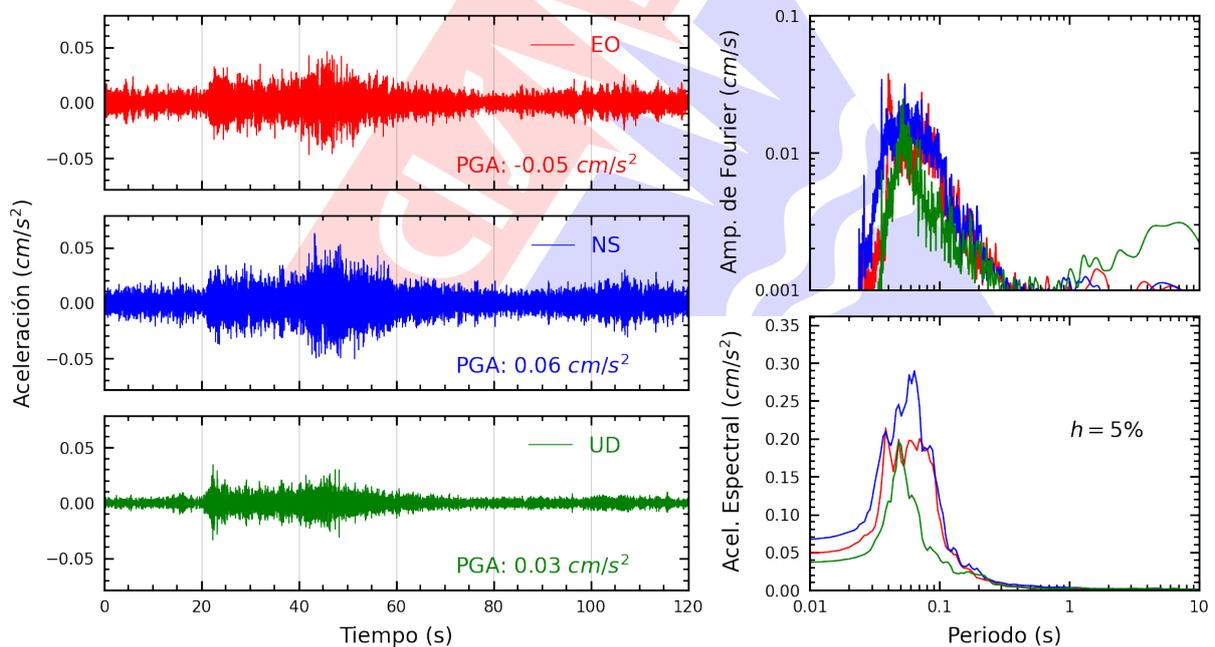
**Figura A.2:** Registros tiempo-historia, espectros de Fourier y de respuesta en las direcciones EO, NS y vertical de la estación UNAM. Sismo de Quilca, Camana - Arequipa del 2025-09-18, 14:16:27 (Hora local)
