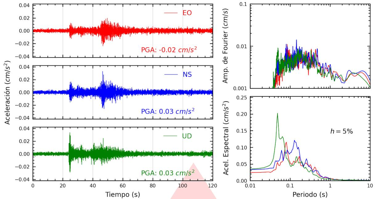
**Figura A.1:** Registros tiempo-historia, espectros de Fourier y de respuesta en las direcciones EO, NS y vertical de la estación UNF. Sismo de Mancora, Talara - Piura del 2025-09-24, 02:43:19 (Hora local)
