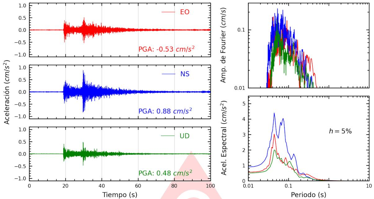
**Figura A.3:** Registros tiempo-historia, espectros de Fourier y de respuesta en las direcciones EO, NS y vertical de la estación UNAM. Sismo de La Capilla, General Sanchez Cerro - Moquegua del 2025-09-26, 18:50:15 (Hora local)
