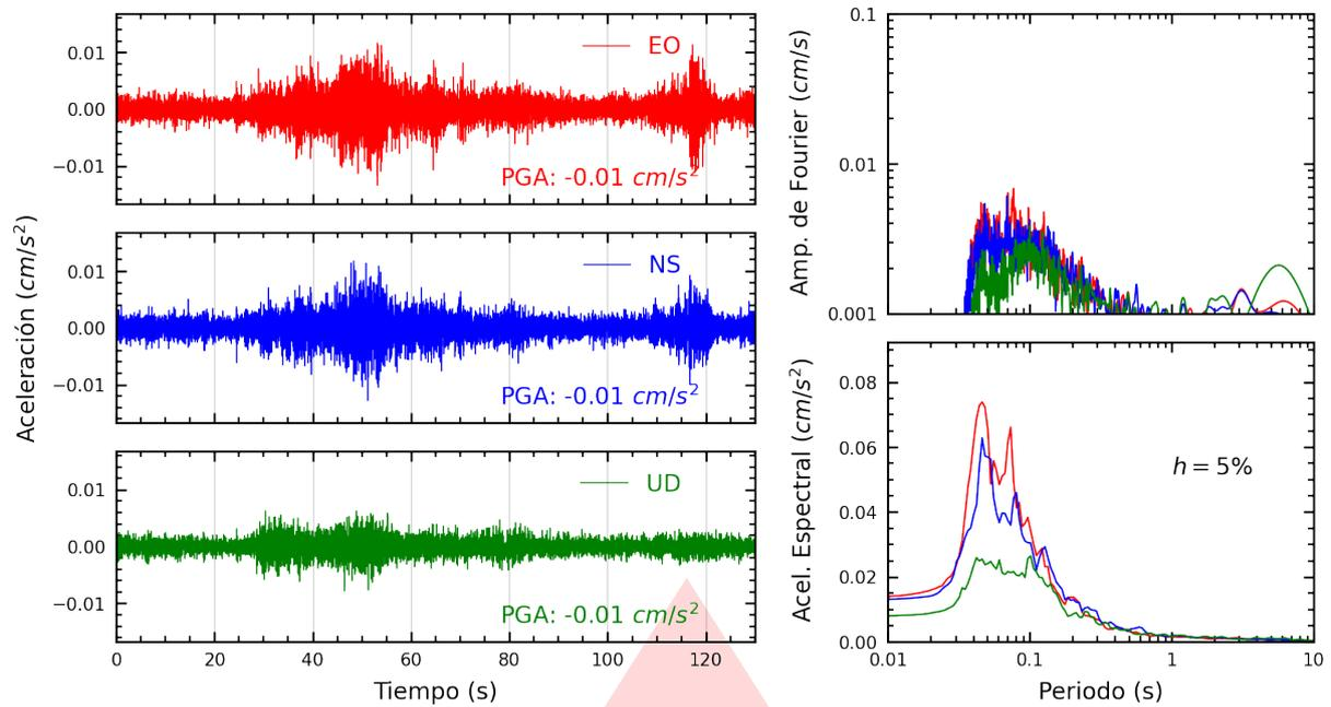
**Figura A.1:** Registros tiempo-historia, espectros de Fourier y de respuesta en las direcciones EO, NS y vertical de la estación UNSA2. Sismo de Maca, Caylloma - Arequipa del 2025-10-02, 15:30:32 (Hora local)
