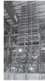
E-defense18階鉄骨実験体
