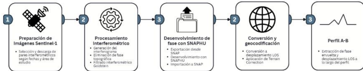
Figura 26 Flujo del procesamiento interferométrico
