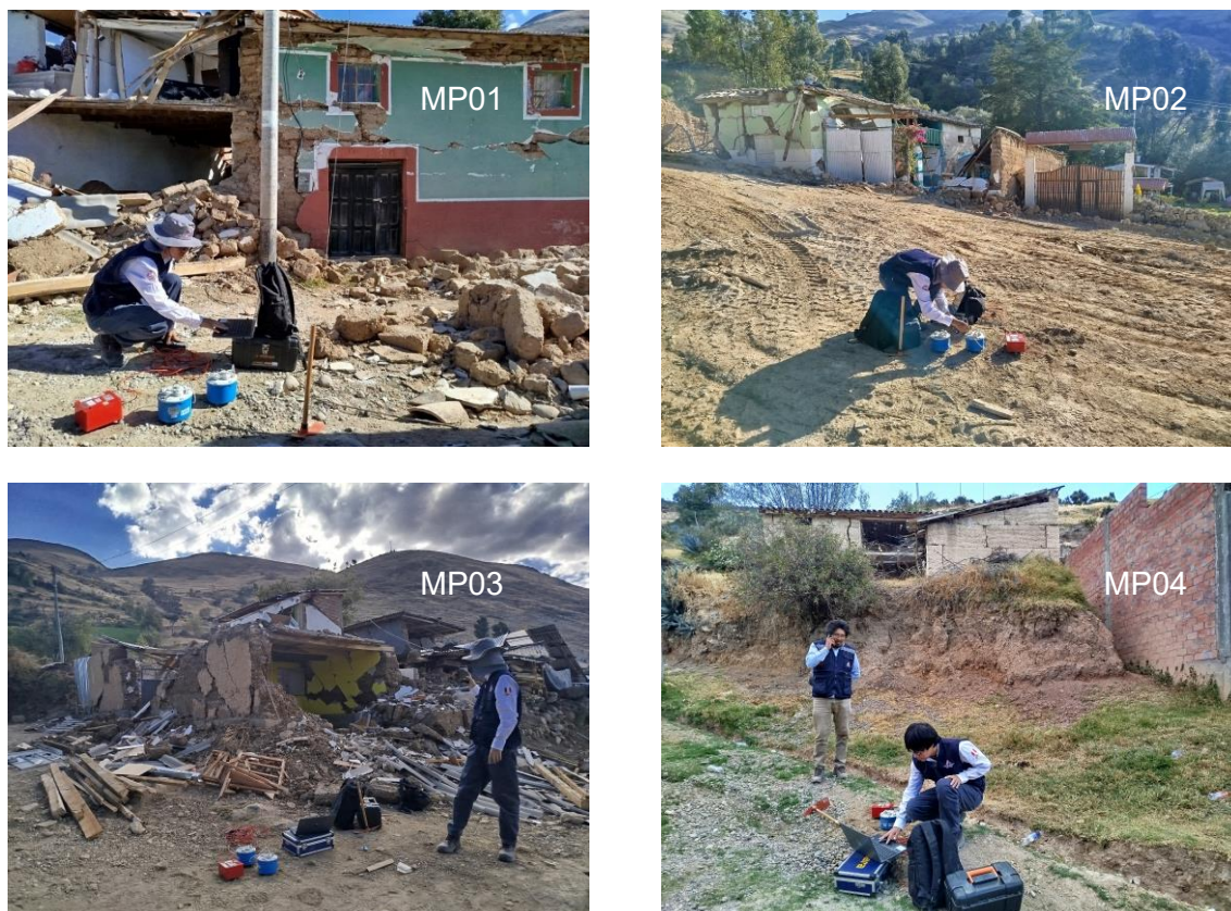
Figura 6 Fotografías de mediciones de microtremores en el anexo de Pumpunya
