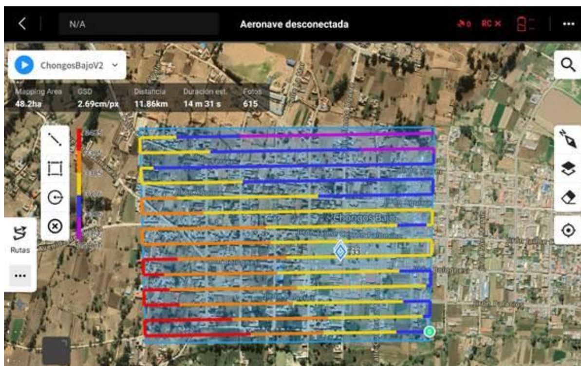
Figura 16 Vista desde el mando de control del plan de vuelo fotogramétrico (Chongos Bajo)
