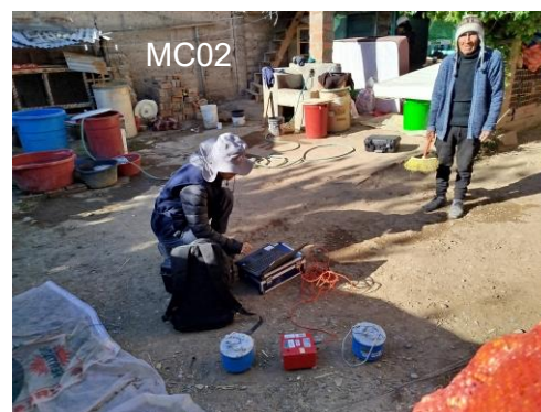
Figura 8 Ubicación de las mediciones puntuales de microtremores ejecutadas en el distrito de Chongos Bajo
