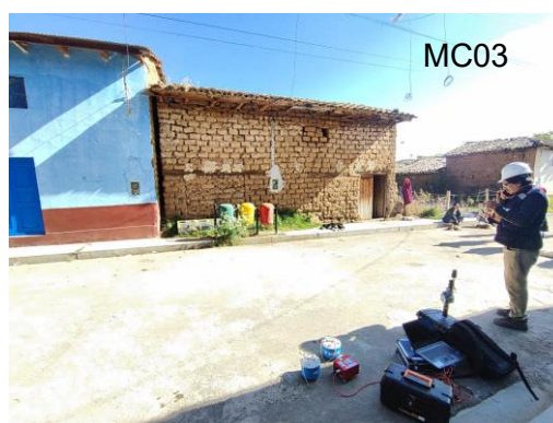
Figura 9 Fotografías de ejecución de mediciones de microtremores en el distrito de Chongos Bajo
