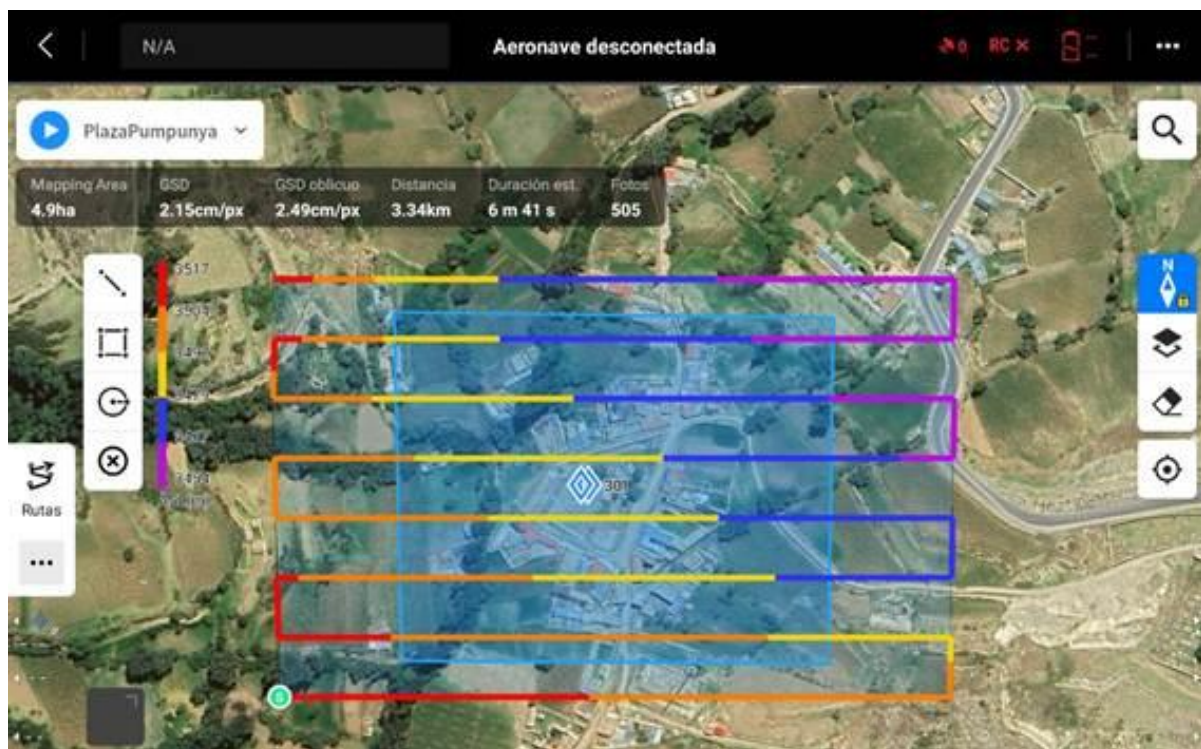
Figura 17 Vista desde el mando de control del plan de vuelo fotogramétrico en (Pumpunya)
