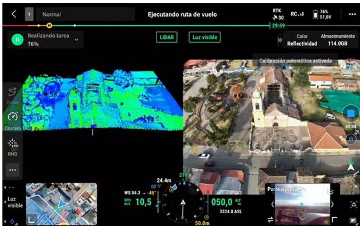
Figura 18 Vista desde el mando de control del sensoramiento LiDAR.
